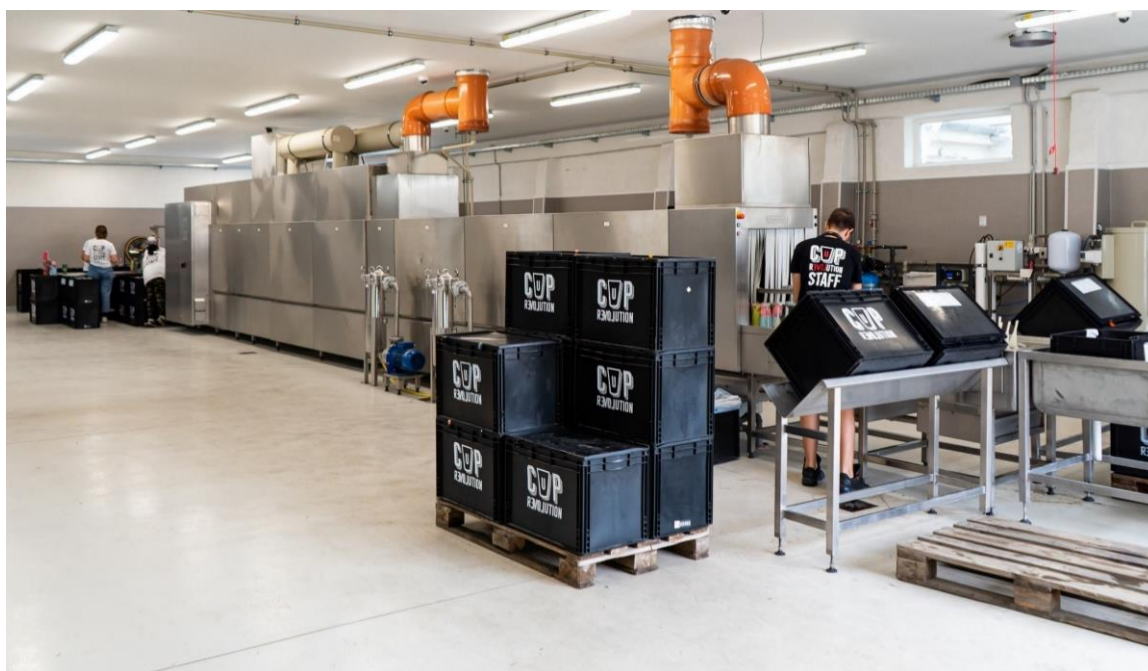
Kép 4: A termékek mosásához használt ipari mosogatógép a Revo Union óbudai telephelyén
